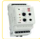
TER-4 Široký a přesný rozsah nastavení -40 až +110 °C v 10-ti rozsazích v jednom přístroji, jemné dostavení teploty, 2 vstupy pro NTC senzor, 2 výstupy 16 A přepínací, doplňující funkce (paměť, hystereze, indikace vadného senzoru) napájení: AC 230 V nebo AC/DC 24 V (galv. oddělené). str. 134
