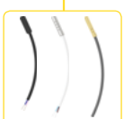
TC, TZ, Pt100 Externí teplotní senzory pro termostaty v délkách 3 m, 6 m, 12 m - TC/TZ: termistor NTC 12 kΩ/25 °C - Pt: článek Pt100 (pouze TER-3G). str. 145
