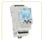
TER-9 2 teplotní vstupy, 2 výstupy 8 A přepínací, 6 funkcí, vestavěné spínací hodiny, podsvětlený LCD, galvanicky odd. napájení AC 230 V nebo AC/DC 24 V, 2 MODUL. Teplotní rozsah: -40 °C až +110 °C. str. 136
